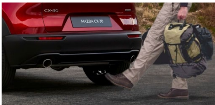
Moduł automatycznego otwierania/zamykania bagażnika poprzez ruch stopą
